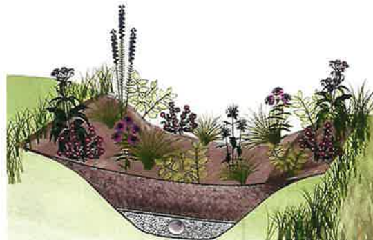
Coupe de principe d'un jardin de pluie avec drains
