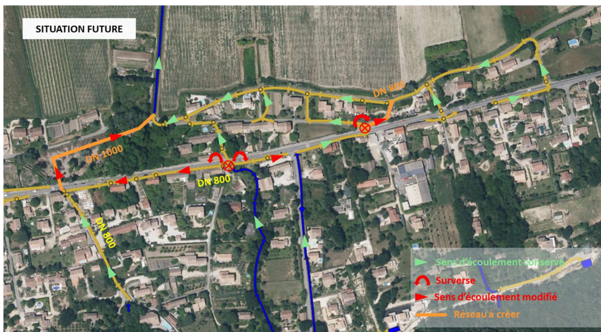
Figure 13 : Schéma de principe de modification des sens d'écoulement
