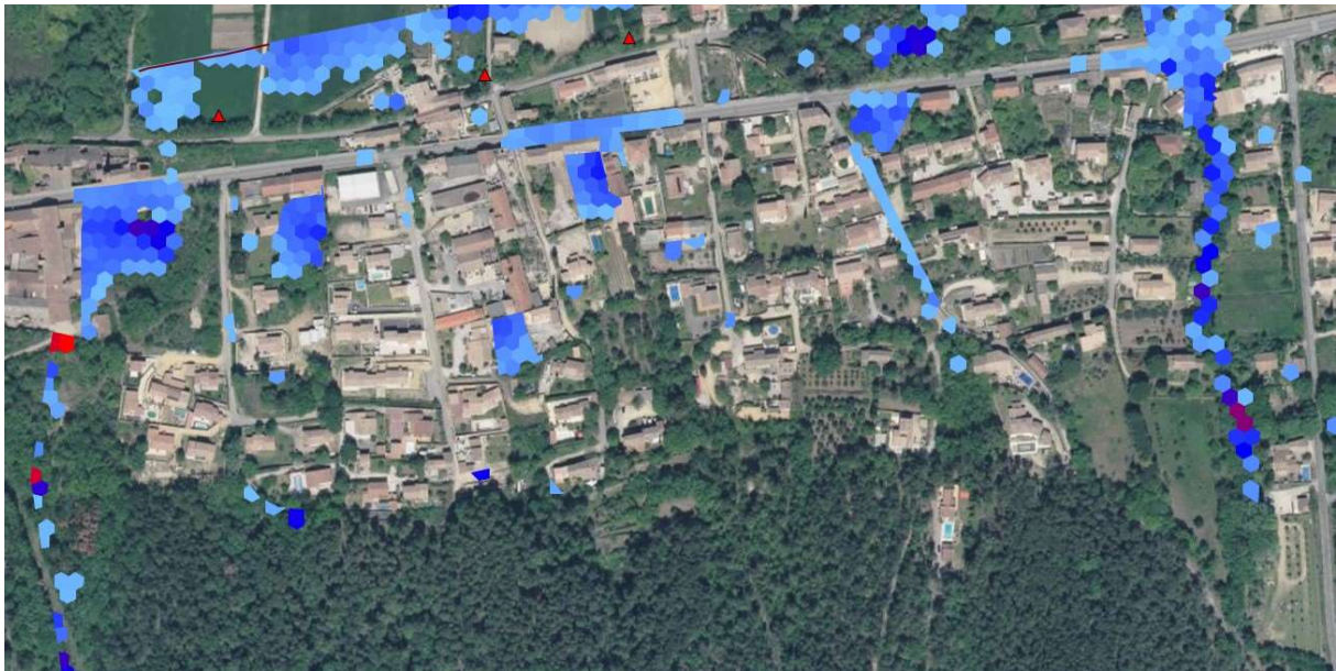
Figure 10 : Modélisation hydraulique des points de débordement
