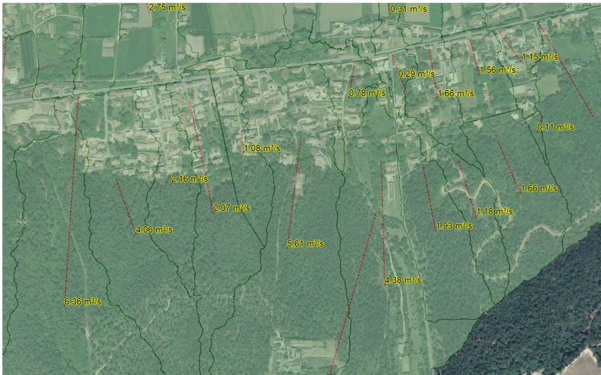
Figure 8 : Calcul des débits max observés par sous-bassin pour une pluie 30 ans
